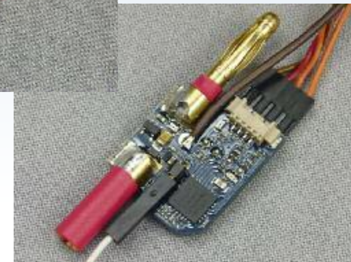
Da ohnehin die Anschlüsse geändert wurden, auch gleich ein Blick ins aufgeräumte und sauber verarbeitete Innere des UniSens-E. Gut zu erkennen: der riesige Shunt zur Strommessung.
