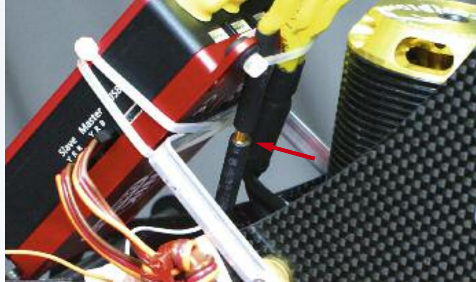
Das Phasensensorkabel wurde mit einem 4-mm-«Durchgangsstecker» verlötet und zwischen eine Motorzuführung gesteckt.
